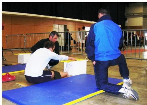
Le 0 de référence de la graduation du dispositif est placé en bordure de la tablette supérieure, à 15 centimètres au-dessus du plan d'appui des pieds.
