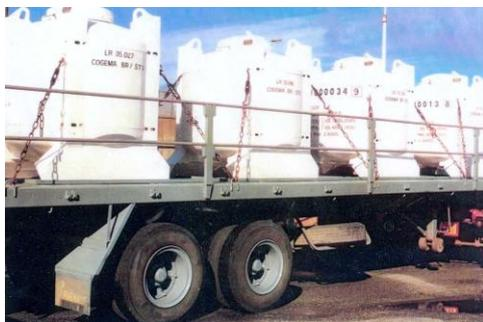
Les emballages de type B sont conçus pour résister aux effets d'un accident de transport en conservant l'intégrité de leurs fonctions de confinement et de blindage.
