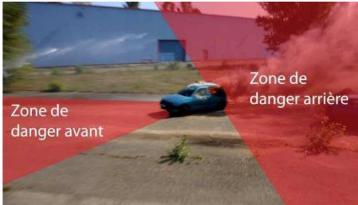
L'engin est placé à 50 mètres minimum, en dehors de l'axe de la zone de danger du véhicule en feu.
