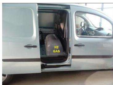
Le système de sécurité est un thermofusible qui se déclenche à une température de 110 °C environ avec vidange du réservoir en 3 minutes sous la forme d'une torchère de gaz enflammée.
