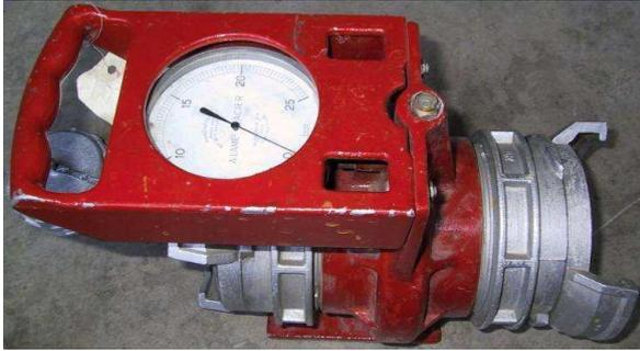
Ils servent à contrôler la pression les pressions statique et dynamique de l'eau à la sortie des hydrants.
