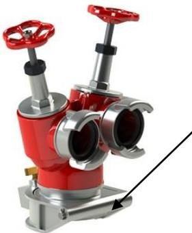
Elles sont composées d'un demi-raccord de 100 mm de type Keyser, qui se positionne sur la douille à rebords saillants de la bouche d'incendie, et de deux ouvertures de 65 mm s'ouvrant et se fermant par des vannes à robinet.
