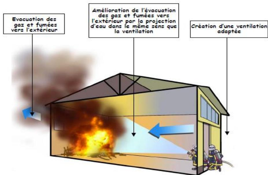
*Mise en œuvre d'une ventilation pour faciliter l'action du binôme*
