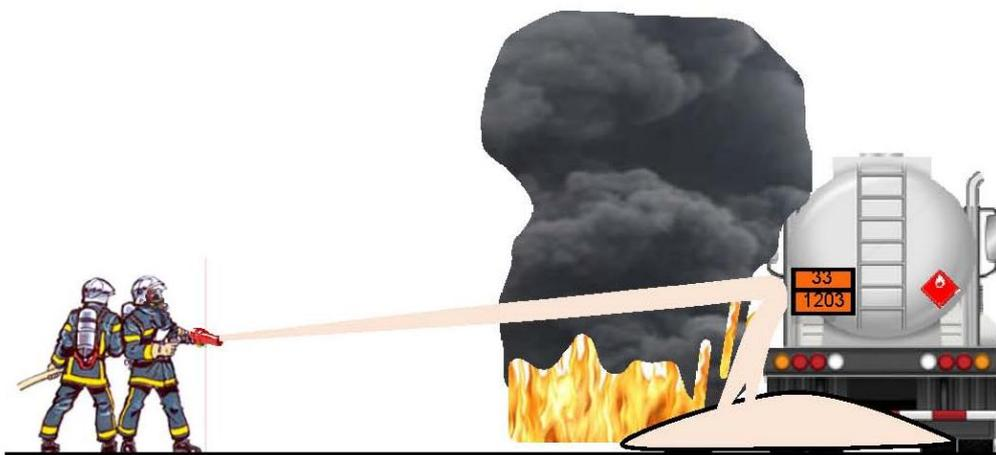
**Le porte lance veille à ne pas déchirer le tapis de mousse et arrête la projection sur la nappe en feu lorsque la mousse baisse de qualité à la lance.
