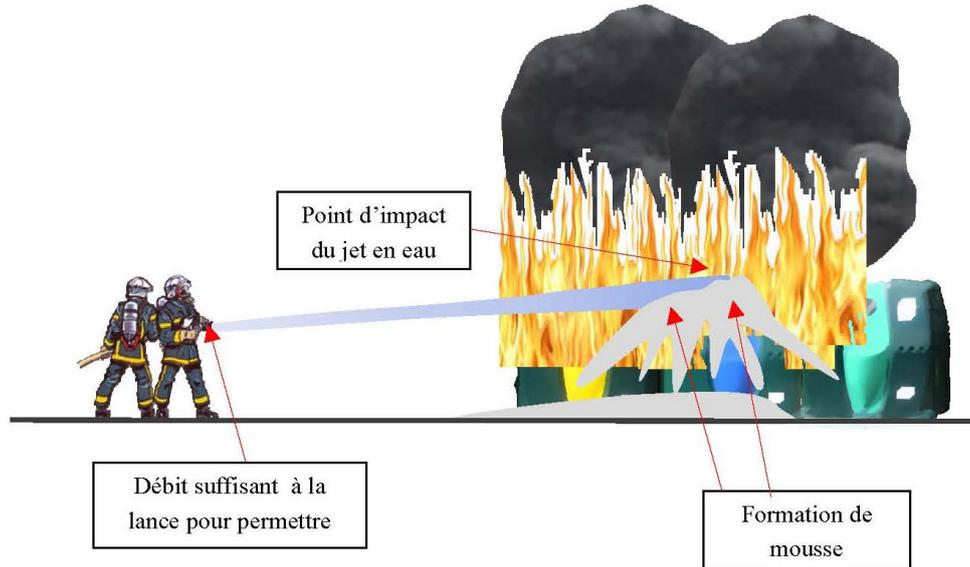
Plus le jet est diffusé, plus la « mousse » se créera sur le trajet avant le point d'impact du jet.
