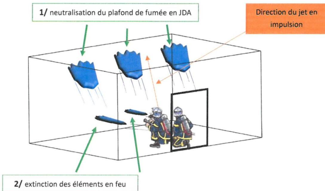
**Le pulsing / penceling** permet de **neutraliser le plafond de fumée** avec des impulsions en jet diffusé d'attaque, puis les **éléments en feu** avec un jet qui couvre les surfaces en feu tout en maîtrisant la quantité d'eau sur un feu en cours de développement.
