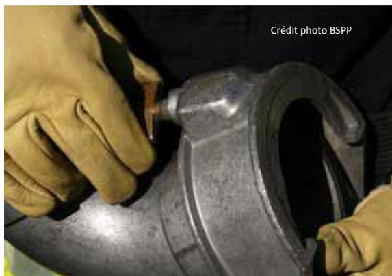
Desserrer la vis papillon du raccord Keyzer ;
