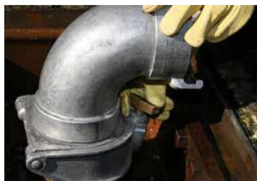
Serrer le vis papillon du raccord Keyzer à la main ;
