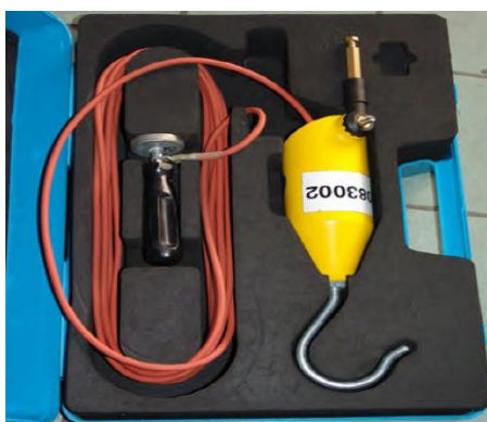
Vérification d'absence de tension (VAT) et patin magnétique
