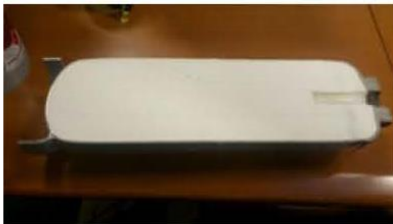
L'intérieur d'une bouteille d'acétylène
