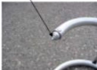
Chaque crochet est terminé par une griffe. Les griffes permettent à l'échelle de ne pas glisser lorsque celle-ci repose sur ses crochets sur un appui de fenêtre par exemple.
