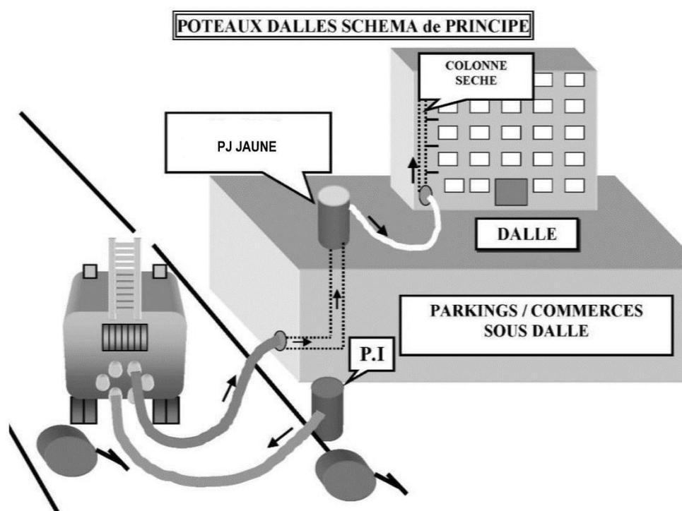
**Colonne sèche alimentée par un poteau relais :** la purge du poteau relais doit se faire avant raccordement de l'établissement d'alimentation de la colonne sèche.
