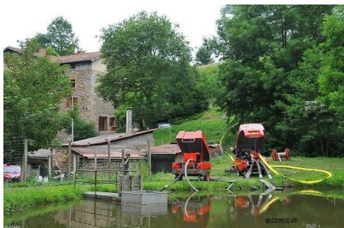
En fonction de l'engin, et si nécessité hydraulique, la ligne d'aspiration peut être doublée.
