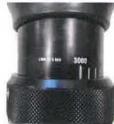
**Réglage du débit manuellement par une bague avec un ergot**
