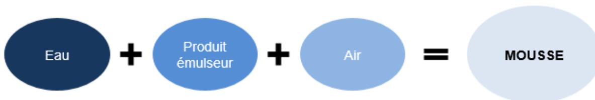
En faisant varier les proportions des éléments de base et la qualité du brassage, on peut obtenir des mousses de consistances différentes. Elle est obtenue par des procédés purement mécaniques.
