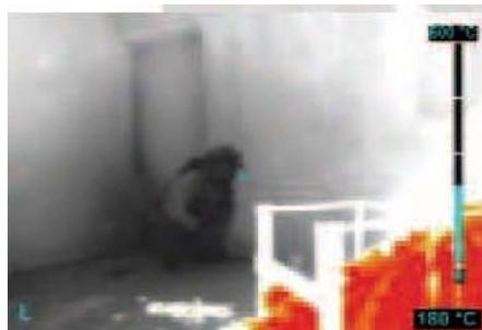
Lorsque la température est inférieure à 560°C, la basse sensibilité offre des vues détaillées des objets dans des environnements à température élevée.
