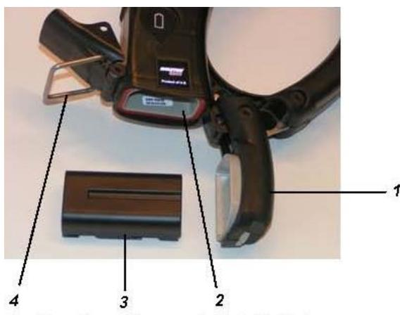
1. Couvercle du compartiment de la batterie sur la poignée de la caméra.
