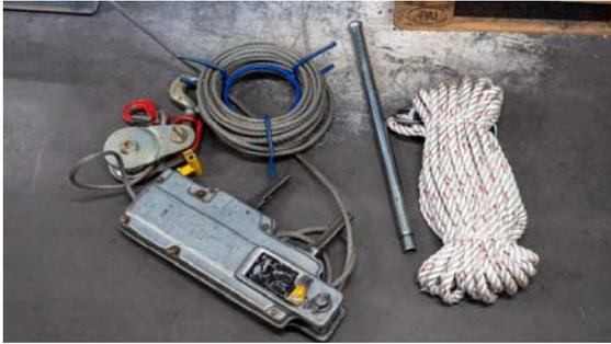
Mise en place d'un Tirfor, d'un cordage :
