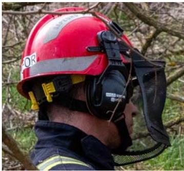
Le **casque de bûcheronnage F2** muni d'une visière grillagée contre les projections d'éclat de bois, un dispositif atténuateur de bruit qu'il convient obligatoirement de mettre en place dès lors que la tronçonneuse est en œuvre.
